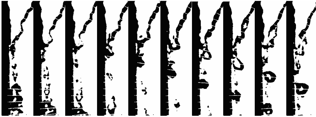
Фиг. 3. Формирование пузырькового следа при \theta_0 = 45^\circ
