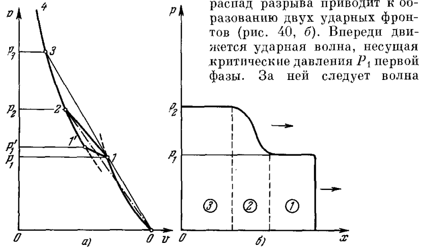
Рис. 40. а) P-v -диаграмма ударного сжатия при наличии фазовых превращений. 0-1 — ударная адиабата первой фазы; 1-1' — область сосуществования двух фаз; 1'-4 — адиабата фазы высокого давления; 1-3 — область существования двух волновых конфигураций. б) Структура ударных волн, сопровождаемых фазовыми превращениями: 1 — область расположения первой фазы; 2 — зона превращения, образованная из смеси двух фаз; 3 — область заверщенного превращения.
