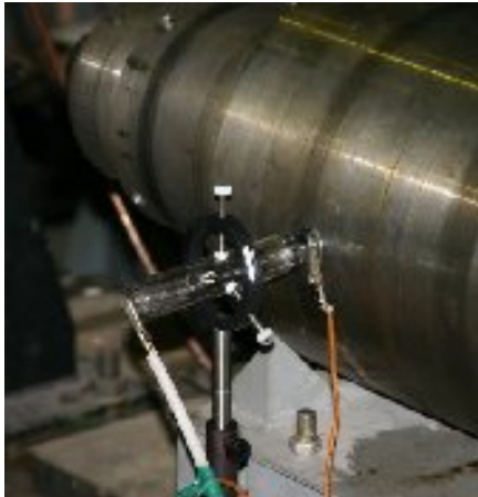
Рентгеновская трубка у диагностического окна разрядной камеры
